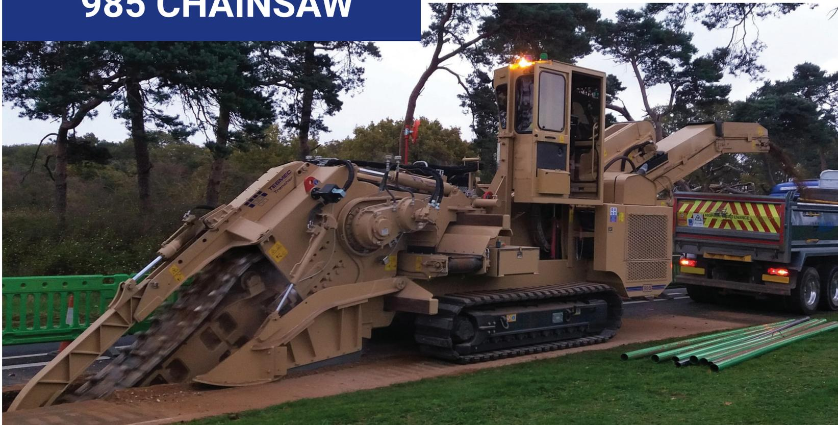
La Tesmec 985 Chainsaw est une trancheuse de 40 tonnes dotée d'un moteur de 375 ch (280 kW), et conçue pour répondre à tous profils de professionnels, des constructeurs d'autoroutes aux entrepreneurs de pipelines, travaillant sur des chantiers où l'espace est l'une des préoccupations principales.
