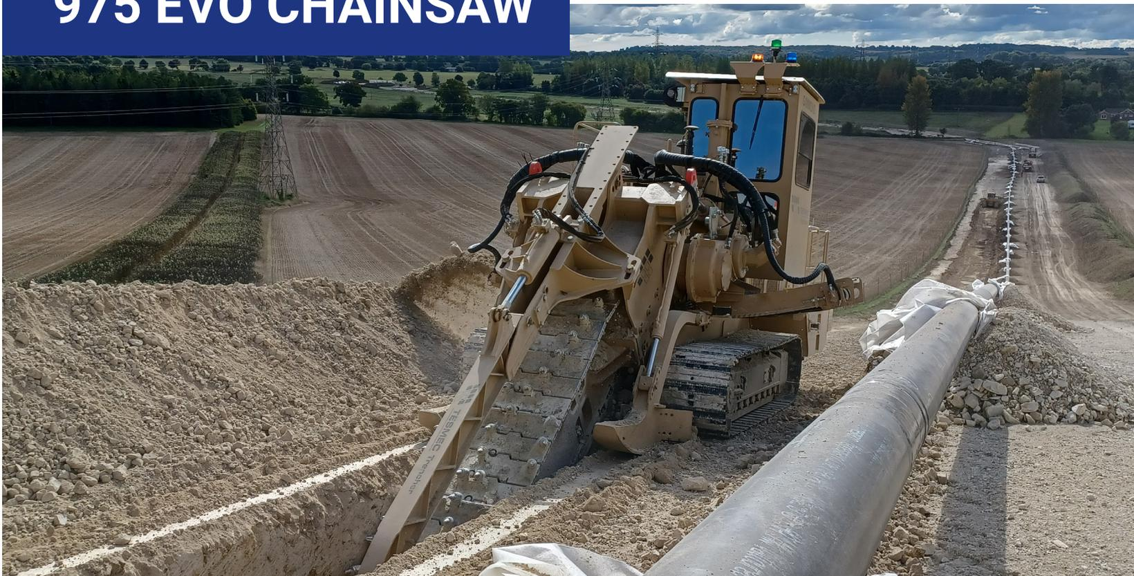
La Tesmec 975 EVO Chainsaw est une trancheuse de 40 tonnes dotée d'un moteur de 375 ch (280 kW) et conçue pour le tranchage dans les sols rocheux pour la pose de fibre optique, câbles électriques, conduites d'eau et pipelines.
