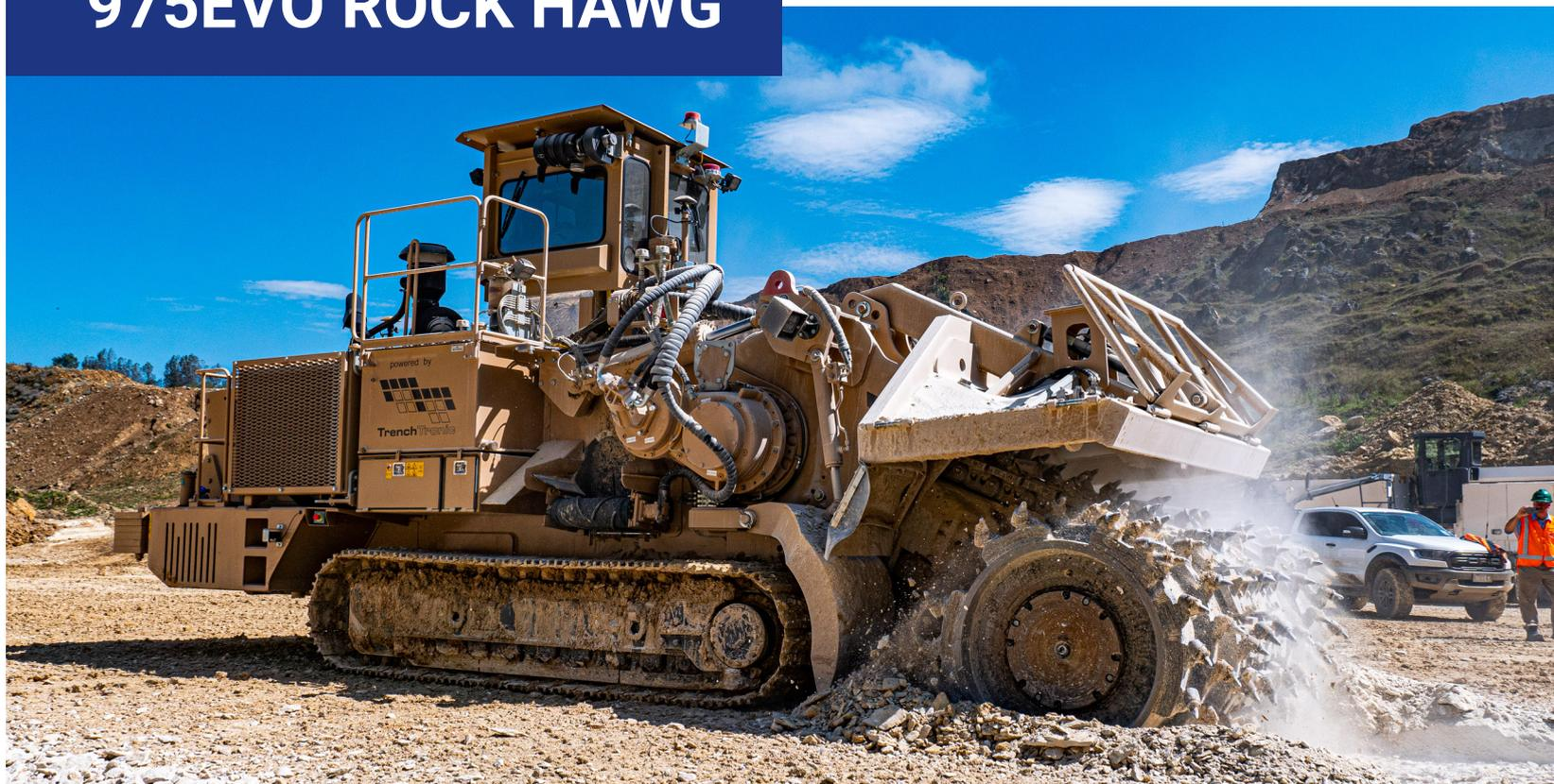
La Tesmec 975 EVO Rock Hawg est une trancheuse de 44 tonnes dotée d'un moteur de 375 ch (280 kW), et conçue pour les chantiers d'excavation de matériaux en vrac, applications en tunnels et exploitation à ciel ouvert.
